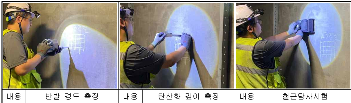
【사진 13.4】 고양분기 전력구 재료시험 전경
